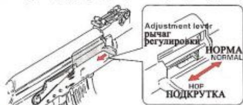
Gradually turn the adjustment dial towards Hop to give hop up to bullets. (The best setting is where bullets fly horizontally.) Постепенно регулируйте шкалу до получения желаемого результата. (Лучший результат - это прямая траектория полета шара.)
