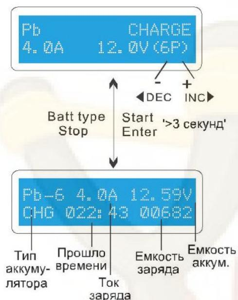
Установите ток заряда слева и номинальное напряжение аккумулятора справа. Диапазон тока зарядки от 0.1 до 10.0 А, напряжение должно соответствовать заряжаемому аккумулятору. Чтобы начать процесс зарядки, удерживайте кнопку START более 3 секунд.
