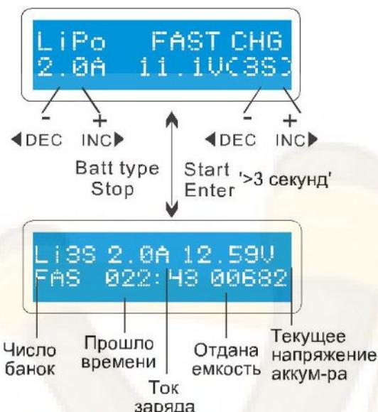
Вы можете установить ток заряда и напряжение заряжаемых аккумуляторов. При нажатии кнопки START/ENTER отобразится подтверждение напряжения. Потом, если Вы подтвердите напряжение и ток, снова нажмите кнопку START/ENTER для начала зарядки.
