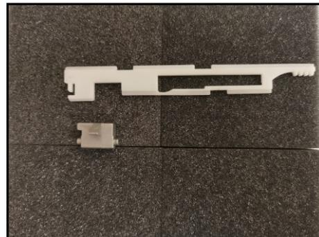
Наклейте белую полоску ( входит в комплект наклеек с Desire V3) на вспомогательную деталь от спускового крючка со стороны которая будет прилегать к левой стенке гирбокса (сторона с платой).
