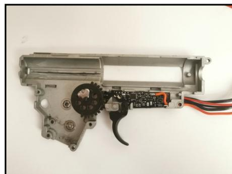
Закройте гирбокс второй стенкой и зафиксируйте на 2 винта.
