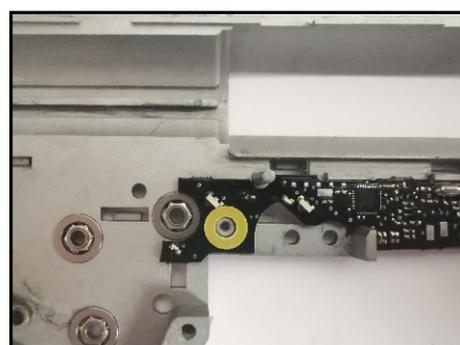
Зафиксируйте плату винтом крепления контактной
