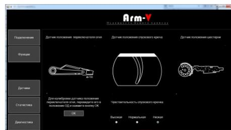
Для проверки датчика переключения режимов огня нажмите на кнопку откалибровать, установите планку селекторы в крайнее заднее положение «параллельно шестерне» и нажмите «Ок»
