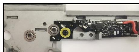
Планку селектора и вспомогательную деталь от спускового крючка необходимо обезжирить. Тщательно промойте эти детали с моющим средством и просушите.
