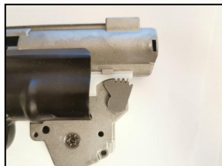
Установите планку селекторы в среднее положение (край «шестерни» вровень со стенкой гирбокса и нажмите «ОК». Теперь при движении из крайнего заднего положения планки селектора в среднее в программе должно отображаться переключение режимов огня.
