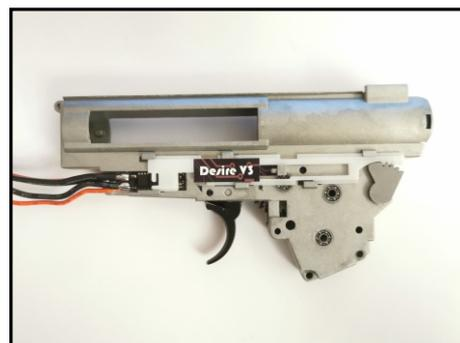
Закройте датчик переключения режимов огня и отверстие под цилиндр от внешнего света, например крышкой ствольной коробки.
