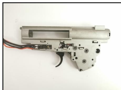
Установите планку селектора и «шестерню» которая ее двигает.
